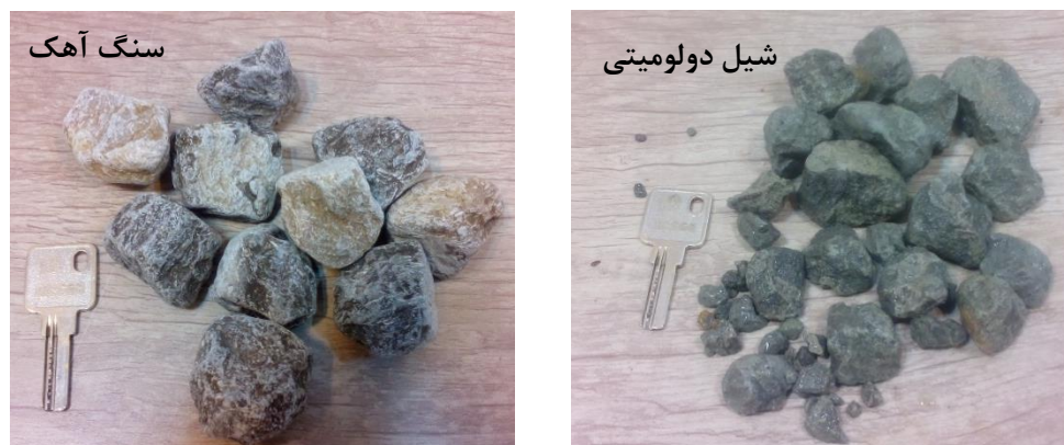
شکل ۱۰. شیل دولومیتی به عنوان کم دوام ترین و سنگ آهک به عنوان با دوام ترین نمونه بعد از چرخه ۱۵ آزمایش دوام وارفنگی در محلول اشباع نمک
