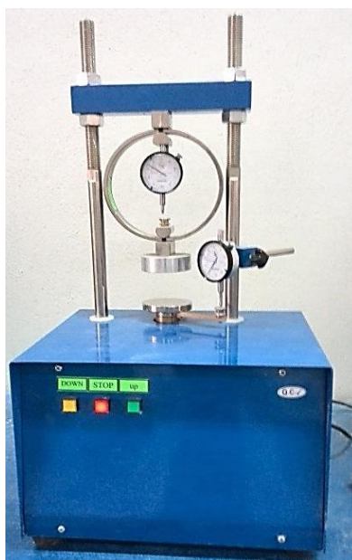
شکل ۱. دستگاه اندازه‌گیری مقاومت فشاری آزاد استفاده شده در تحقیق
