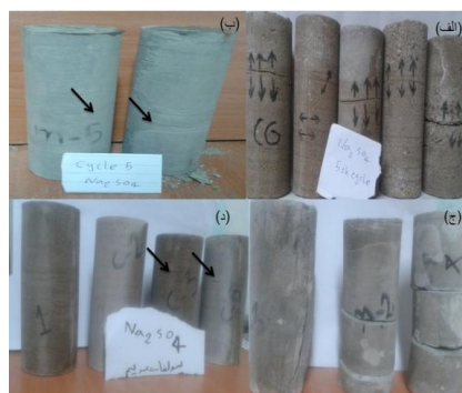
شکل ۹. تخریب نوع دوم: تخریب اتفاق افتاده در نمونه‌های ماسه سنگی در امتداد سطوح ضعیف از پیش موجود و لامینه‌ها، الف) نمونه CG، ب و ج) نمونه Min و د) نمونه C. (قطر نمونه‌ها ۵/۴ سانتی‌متر و طول آن‌ها ۱۴ سانتی‌متر است)
